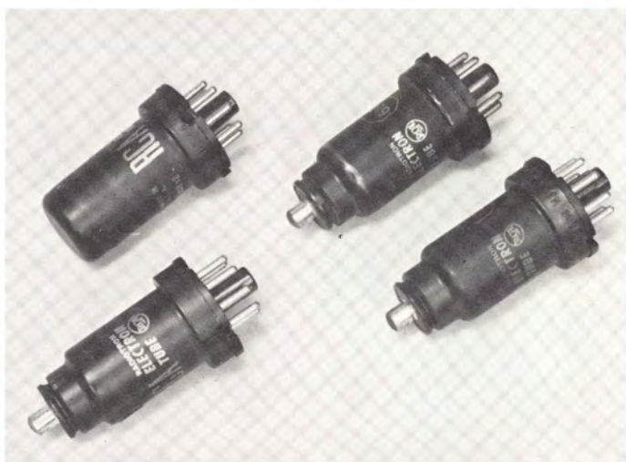
Fig. 8 - Altri tubi - pseudo-ghiana" Wehrmacht, da considerarsi, all'epoca in cui furono progettati, veri capolavori di tecnica. I modelli sono RV12P2000 ed STV150/15, il loro valore è intorno alle 1.000 lire l'uno se usati, ed il doppio nuovi; il triplo se nella scatola originale.
